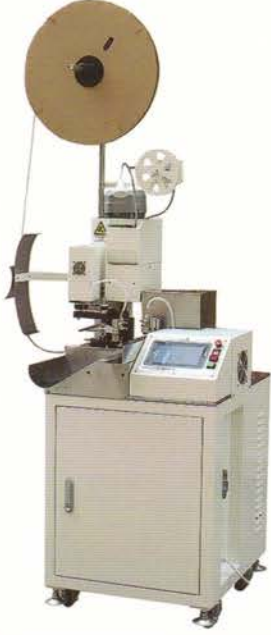
HSR201 - TAM OTOMATİK KABLO KESME, SIYIRMA ve KRİMPLEME MAKİNASI • Tek Taraf Siyirma ve Krimpleme • Tek Taraf Siyirma
