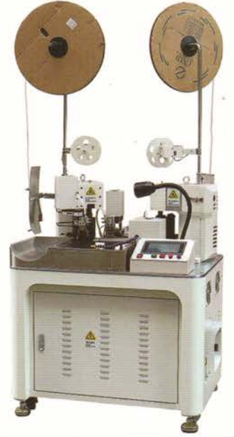
HSR205 - TAM OTOMATİK KABLO KESME, SIYIRMA ve KRİMPLEME MAKİNASI • Tek Taraf Siyirma ve Çiftleme • Tek Taraf Siyirma ve Krimpleme • Tek Taraf Siyirma
