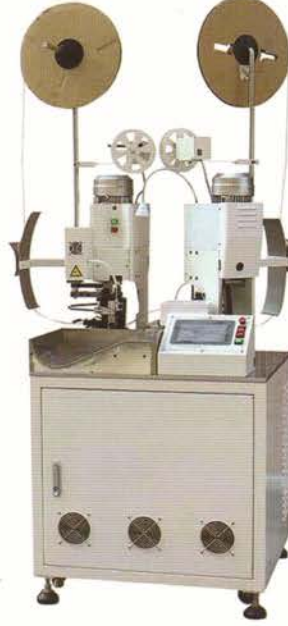
HSR202 - TAM OTOMATİK KABLO KESME, SIYIRMA ve KRİMPLEME MAKİNASI • Çift Taraf Siyirma ve Krimpleme
